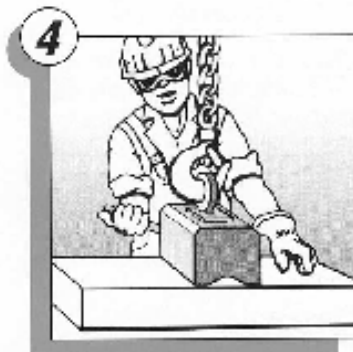
Setzen Sie den Magnetheber in die Mitte des Schwerpunktes des anzuhebenden Teils.
