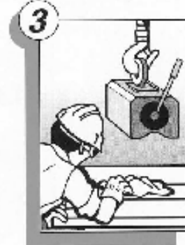
Reinigen Sie die Polflächen des Magnethebers und die Berührungsfleichen des anzuhebenden Teils; befreien Sie die Flächen ggf. von Graß.
