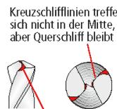
Von der Nebenschneidkante des Bohrers wurde nicht genug Material abgeschliffen.
