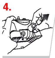
Entfernen Sie die abgenutzte Scheibe, indem Sie diese leicht drehen und vom Schaft ziehen. Setzen Sie die neue Scheibe, die Scheibenhalterung sowie die Schrauben wieder ein. Ziehen Sie die Befestigungsschrauben nicht zu fest an. Entfernen Sie den Schraubenschlüssel und setzen Sie die Schleifscheibenabdeckung wieder ein, bevor Sie die Maschine in Betrieb nehmen.
